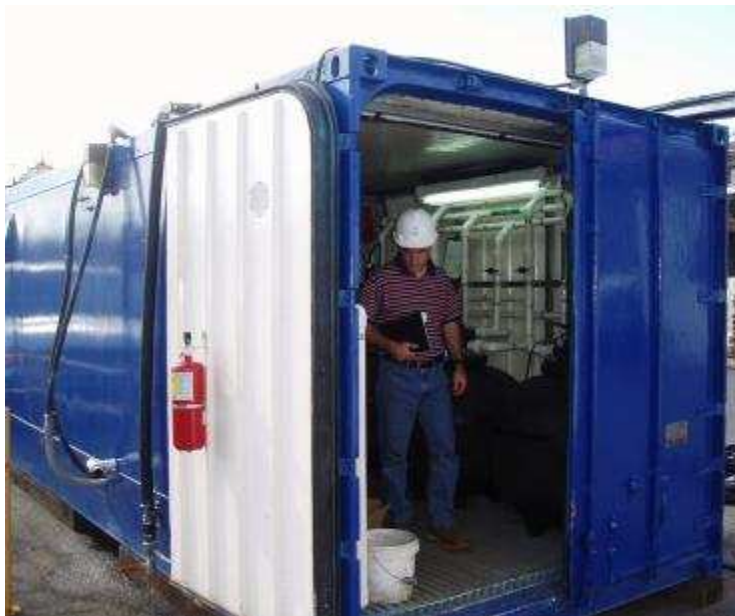
Unité de traitement mobile construite à l'intérieur d'un conteneur marin isolé
